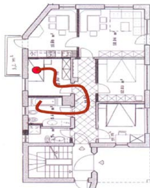
Sistema di sollevamento a binario continuo che collega camera e bagno (per accedere a vasca e/o wc direttamente da letto). La linea rossa rappresenta il binario continuo.
